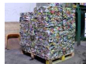
アルミ缶（プレス品） リサイクル工場へ出荷 (アルミ缶に再生)
